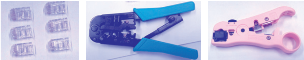
↑ ตัวอย่างอุปกรณ์แจ๊ค RJ45 และคีมสำหรับการเข้าหัวสาย
