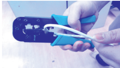
↑ ตัวอย่างอุปกรณ์แจ๊ค RJ45 และคีมสำหรับการเข้าหัวสาย
