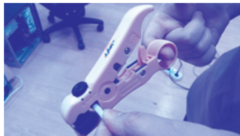
↑ การตัดสายและปอกสายยูทีพี
