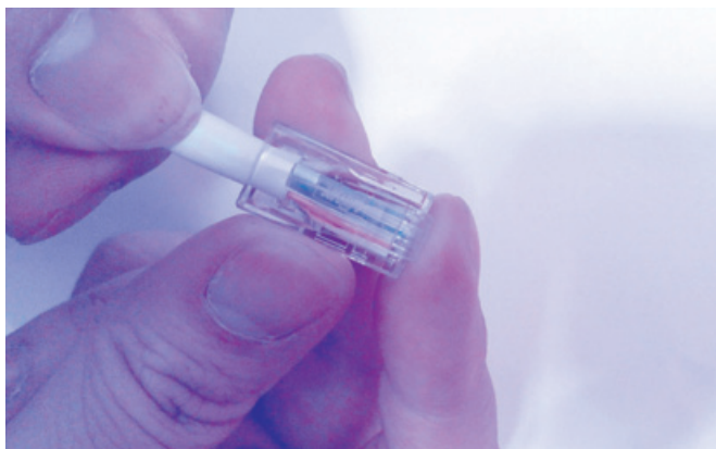
↑ การใส่สายสัญญาณเข้ากับหัว RJ45 ตามมาตรฐาน 568A และ 568B
