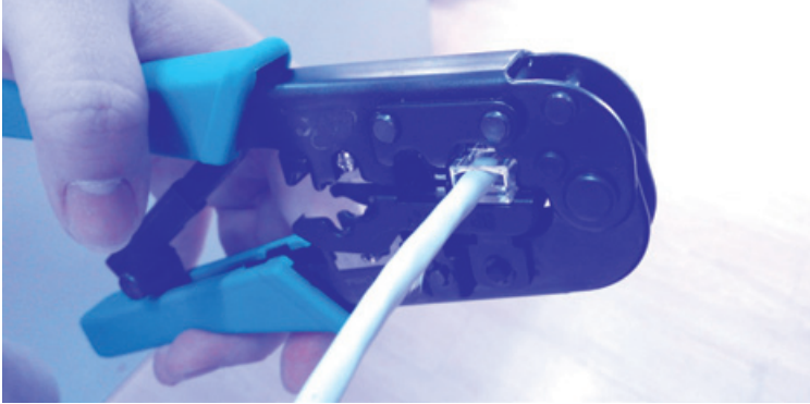
↑ การบีบหัว RJ45 เข้ากับสายแลน
