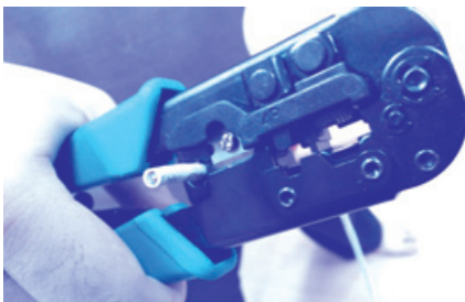
↑ การตัดสายและปอกสายยูทีพี
