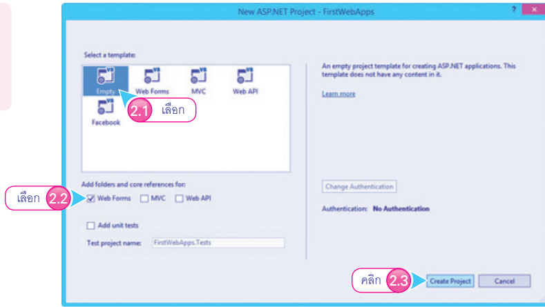
รูปที่ 2-2 แสดงการเลือก ชนิดโปรเจกต์ที่ ต้องการสร้าง
