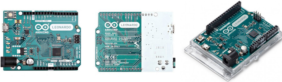
▲ รูปแสดงบอร์ด Arduino LEONARDO with Headers ในมุมมองต่างๆ
