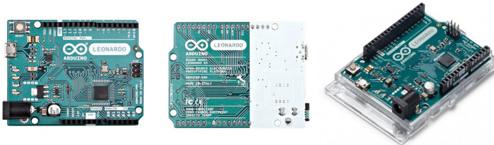
▲ รูปแสดงบอร์ด Arduino LEONARDO with Headers ในมุมมองต่างๆ
